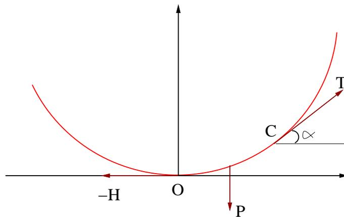
Figura 3: Um Trecho **OC** do Cabo
