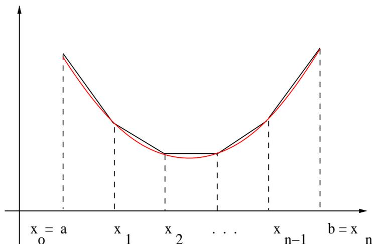
Figura 5: Cabo Suspenso como uma Poligonal
